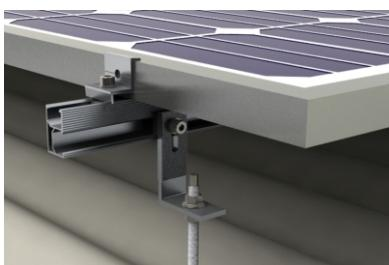
Com o grampo terminal no perfil, Certifique-se que todos os contatos sejam feitos. Fixar os parafusos dos grampos com torque de 15Nm. e depois do aperto verificar se os módulos ficaram corretamente fixados.
