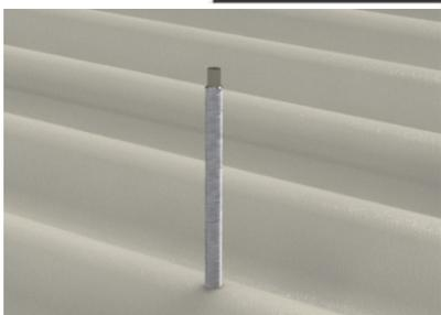
Fazer um furo na água alta da telha ou retirar um parafuso de fixação da telha. Inserir o prisioneiro na terço utilizando uma parafusadeira com soquete (bit) de 7mm.
