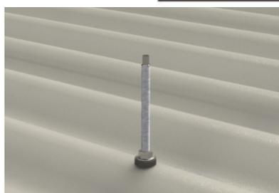
Para vedar o furo, pressionar a borracha de vedação contra a telha até 6mm sobre o telhado com o auxílio da porca.
