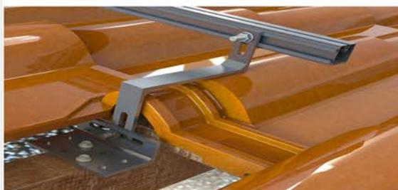
Posicionar e montar o gancho de maneira que a peça em Z acompanhe a parte alta da telha. Fixar a base com dois parafusos de 6mm de diâmetro. Cada fileira de furos da base deve conter pelo menos um parafuso.
