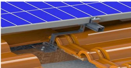
O perfil tem forma "espelhada" então poderá ser fixado ao parafuso cabeça martelo independente do lado .
