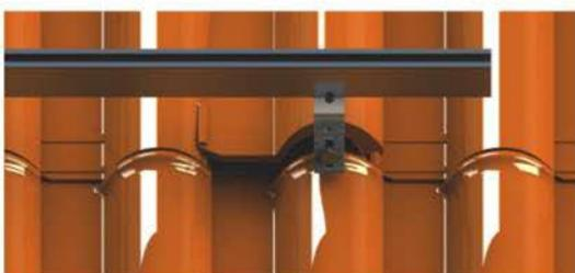
Fixar o perfil no gancho utilizando o parafuso cabeça-martelo e porca. Pode-se instalar o gancho até 0,5m da extremidade do perfil.
